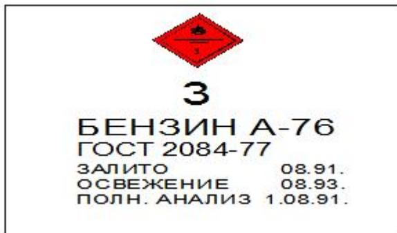
Рис. 6. Пример маркировочной таблицы для резиноканевого резервуара
