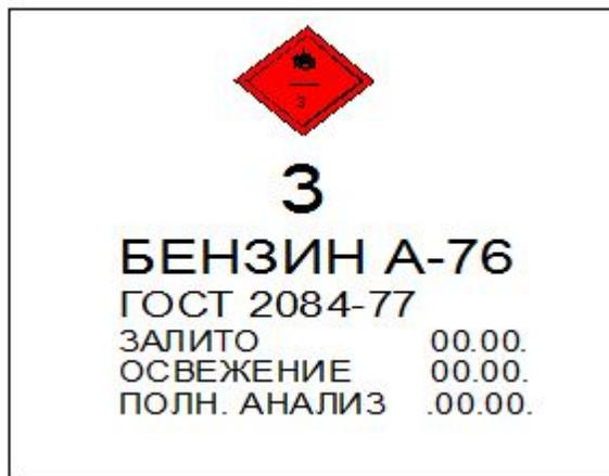
Рис. 3. Пример маркировки резервуара, заполненного горючим
